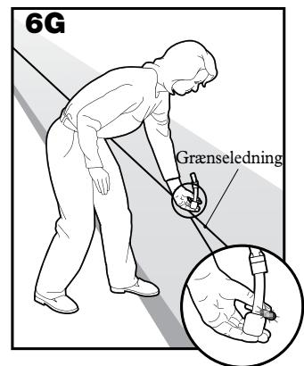
Tallene på knappen til grænsestørrelseskontrol angiver signalstyrken, og kan ikke tolkes som grænsestørrelsen. Hvis det ikke hjælper at stille på grænsestørrelsesknappen for at opnå den ønskede afstand, skal du skifte over til en anden stilling på grænsekontrolkontakten for at opnå den ønskede afstand. Hvis der anvendes en dobbelt sløjfe, kan det være nødvendigt at forøge adskillelsen af afgrænsningsledningen for at opnå det ønskede område.
